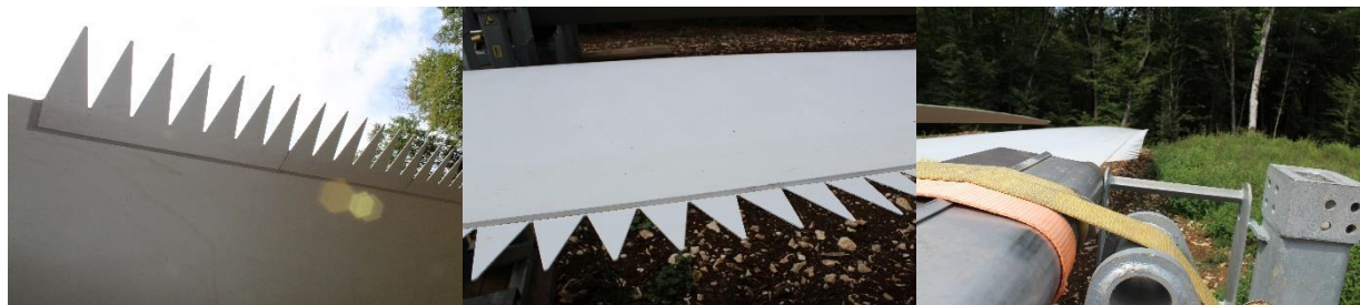
Figure 17 : serrations, équipant le bord des pales.
